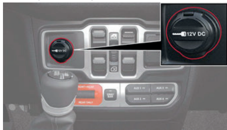
Извод за ток на арматурното табло
