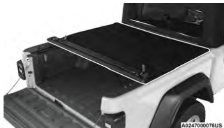
Cubierta tonneau con compuerta trasera en posición intermedia
