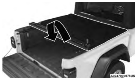
Girar la cubierta Tonneau hacia atrás
