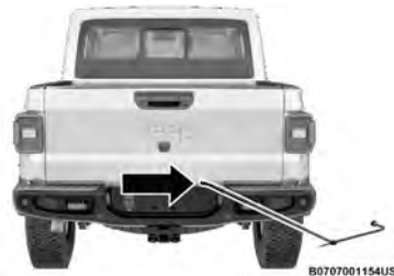
Inserción de las extensiones en el orificio de acceso del mecanismo de cabrestante
