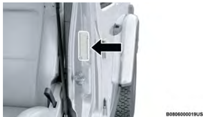
Ubicación de ejemplo de la etiqueta de neumáticos (pilar B)
