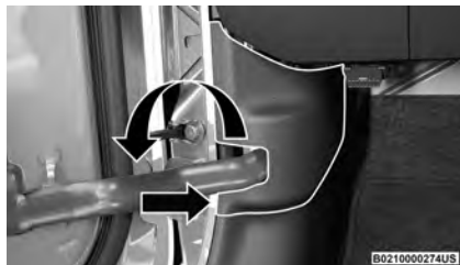
Puerta de acceso al cableado
