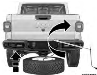
Reinstalar el neumático desinflado o de repuesto
