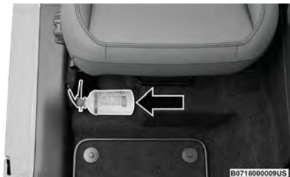
Ejemplo de ubicación del extintor de incendios
