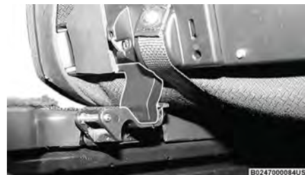
Retenedor colocado correctamente
