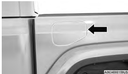
Compuerta de llenado de combustible
