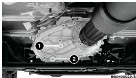
Caja de transferencia
