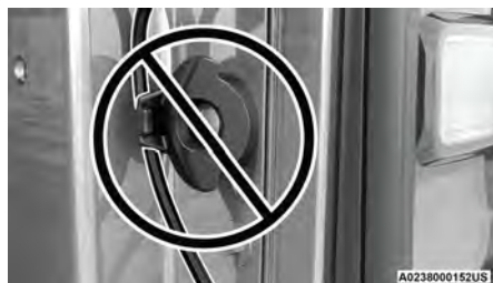
Correa de la compuerta trasera incorrectamente asentada
