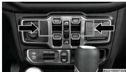
Interruptores de las ventanas eléctricas
