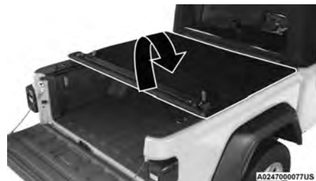
Enrollar la cubierta Tonneau hacia delante
