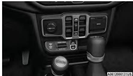
Interruptor de la BARRA ESTABILIZADORA
