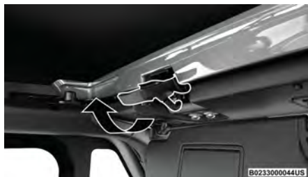
Acoplar ambos pestillos del cabezal
