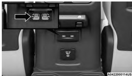
USB (solo carga) en la parte posterior de la consola central
