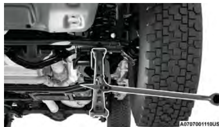
Posición frontal de elevación con gato
