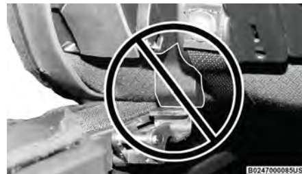
Retenedor colocado incorrectamente
