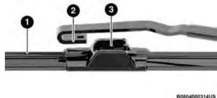
Plumilla del limpiador con pestaña de liberación en posición desbloqueada
