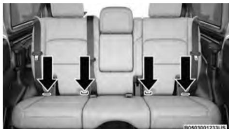
**Anclajes ISOFIX (modelos de cuatro puertas)****Localización de los anclajes de sujeción**
