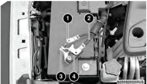
**Desconexión del cable de la batería**
