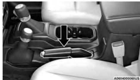
**Palanca del freno de estacionamiento**
