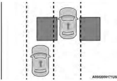
Cuando el vehículo arranca, la luz de advertencia del monitor de ángulos muertos (BSM) se enciende momentáneamente en los dos espejos retrovisores externos para informarle al conductor que el sistema funciona. Los sensores del sistema monitor de ángulos muertos funcionan cuando el vehículo está en cualquier marcha de avance y entra al modo de reposo cuando el vehículo se encuentra en PARK (estacionamiento) (P).
