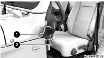
**Fijación del soporte del retrovisor al vehículo**
