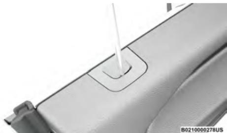
**Coloque la herramienta en el orificio de mantenimiento del tapón para extraerlo**
