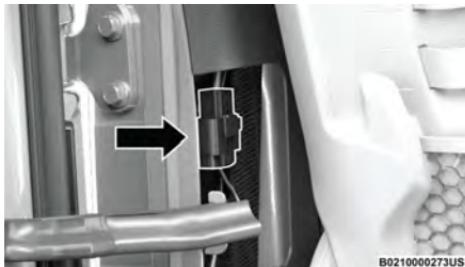
6. Quite el tornillo de retención de la retención central de la puerta (con un destornillador de cabeza Torx n.º 40).
