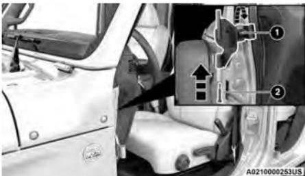
**Fijación del soporte del retrovisor al vehículo**
