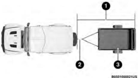
**Detección de la longitud del remolque**
