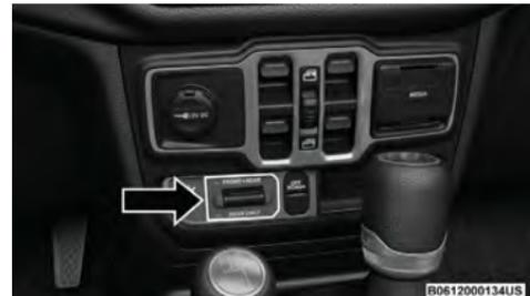
**Tablero del interruptor de bloqueo del eje**
