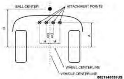
**Puntos de enganche del remolque y medidas del saliente**
