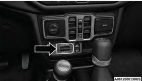
**Tablero del interruptor de bloqueo del eje**
