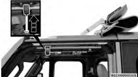
**Fijar el perno del riel de la puerta delantera**
