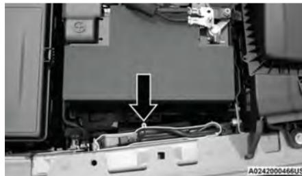
**Conecciones del interruptor auxiliar - Debajo del capó**
