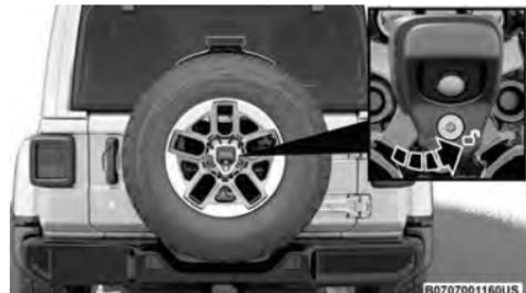
**Desbloquear la cubierta de la cámara trasera**
