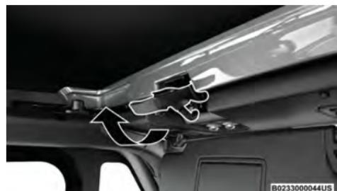
**Acoplar ambos pestillos del cabezal**
