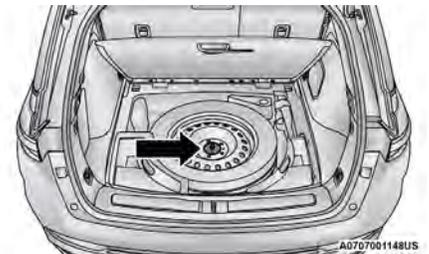
Fijación del neumático de repuesto
