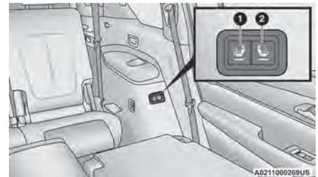
**Interruptores de plegue eléctrico del pilar C (se muestra el lado izquierdo)**
