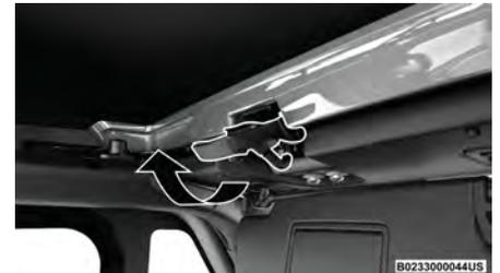
**Acoplar ambos pestillos del cabezal**
