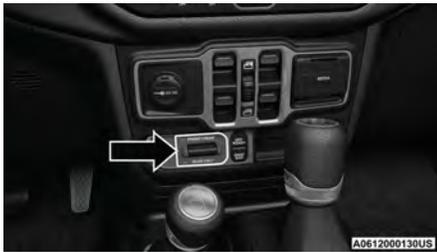
**Tablero del interruptor de bloqueo del eje**
