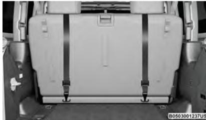
**Montaje de la correa de atadura (modelos de dos puertas)**
