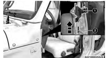
**Fijación del soporte del retrovisor al vehículo**
