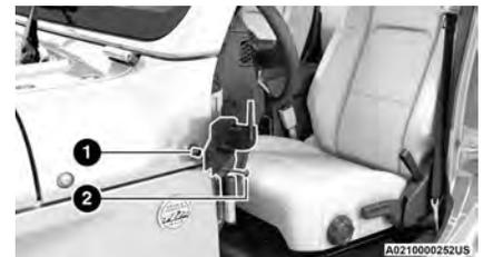
**Fijación del soporte del retrovisor al vehículo**
