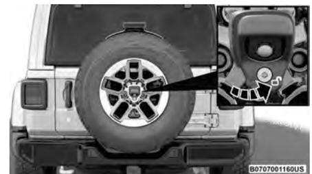
**Desbloquear la cubierta de la cámara trasera**
