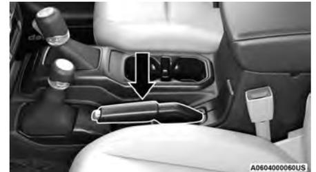
**Palanca del freno de estacionamiento**
