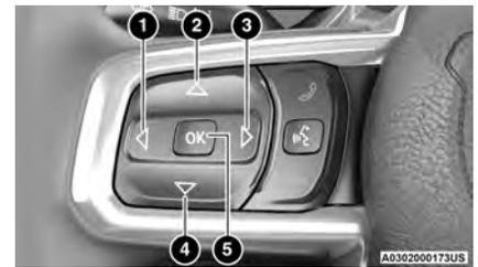
Botones de control de la pantalla del tablero de instrumentos
