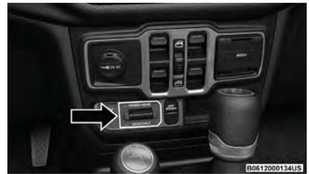
**Tablero del interruptor de bloqueo del eje**
