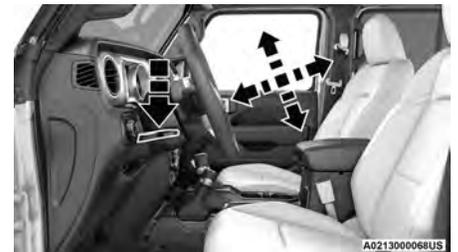
**Palanca de inclinación/telescópica de la columna de la dirección**
