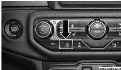
**Interruptor OFF (Apagado) del sistema de Detención/Arranque**
