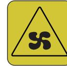
PUEDE ARRANCAR AUTOMÁTICAMENTE TAMBIÉN CON EL MOTOR APAGADO
