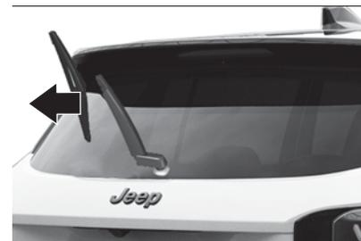
332 Levante el brazo del limpiaparabrisas. Desenganche la escobilla limpiaparabrisas como se muestra en fig. 332 y retírela.
