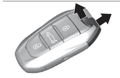
25 Llave electrónica: pulse el pestillo fig. 25 para sacar la llave integral. JJ000563
