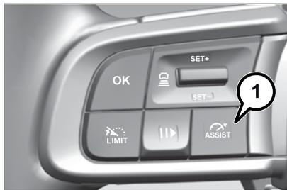
222  Pulse el botón (1) fig. 222 sucesivamente hasta que aparezca el modo de asistencia al conductor en carretera en el cuadro de instrumentos  tras unos segundos, se selecciona el modo de asistencia al conductor en carretera. La minivista de ayudas a la conducción aparece en el cuadro de instrumentos:
