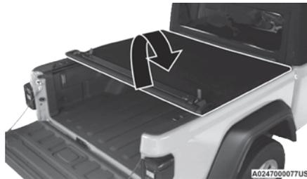
Enrollar la cubierta Tonneau hacia delante
