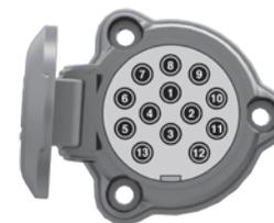
Conector de 13 clavijas (si está equipado)
