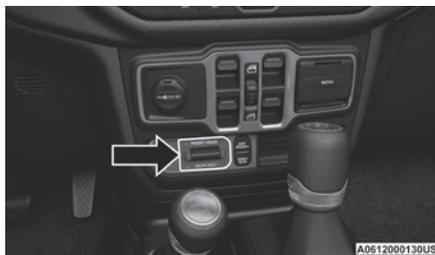
Tablero del interruptor de bloqueo del eje
