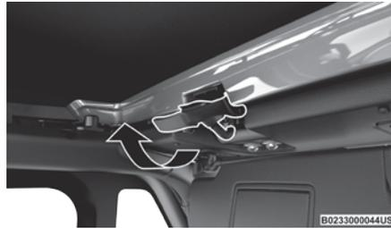
**Acoplar ambos pestillos del cabezal**
