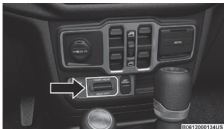
Tablero del interruptor de bloqueo del eje
