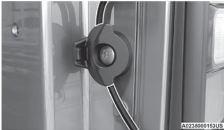
Correa de la compuerta trasera correctamente asentada
