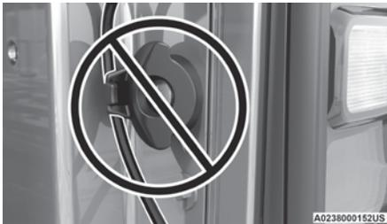
Correa de la compuerta trasera incorrectamente asentada
