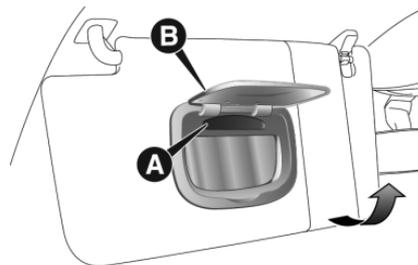
Los plafones de luces de cortesía se encienden automáticamente levantando las tapas **B**.
