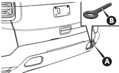
Versiones Trailhawk: el gancho de remolque **A**, de tipo fijo está fijado a la carrocería del vehículo en la parte trasera.
