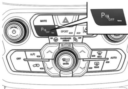
El cambio de estado del sistema, de conectado a desconectado y viceversa, siempre se ve acompañado por un mensaje específico visualizado en la pantalla del cuadro de instrumentos.
