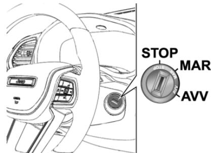
El conmutador de arranque está equipado con un mecanismo de seguridad que obliga, en caso de falla en el arranque del motor, a reponer la llave en la posición **STOP** antes de repetir la maniobra de arranque.
