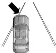
Al detectar una salida o aproximación involuntaria de la línea límite de carril, el sistema puede aplicar una fuerza correctiva en el volante para evitar la salida.
