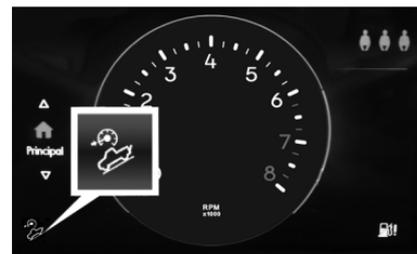
La velocidad programada para el sistema HDC puede regularse mediante el pedal del freno y el del acelerador (en un intervalo de 1 km/h a 25 km/h). La velocidad programada para el sistema HDC puede regularse mediante el pedal del freno y el del acelerador (en un intervalo de 1 km/h a 25 km/h). Tras alcanzar la velocidad deseada, soltando los dos peda-
