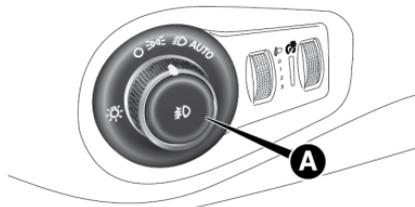
La iluminación exterior sólo se activa con el dispositivo de arranque en posición **MAR**.
