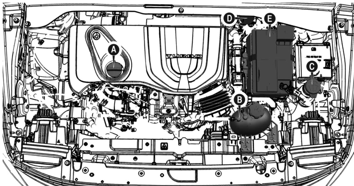
A. Aprovisionamiento de aceite del motor y varilla de control del nivel del aceite del motor – B. Depósito del líquido de refrigeración del motor – C. Aprovisionamiento del líquido del lavaparabrisas – D. Aprovisionamiento del fluido de los frenos – E. Batería
