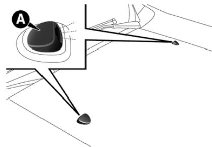
A continuación, comprobar que los orificios de salida no estén obstruidos; si así fuera, utilizar una aguja para destaparlos.
