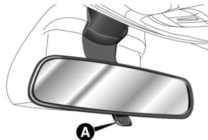
El espejo retrovisor interno está equipado con un dispositivo para la prevención de accidentes que permite desengancharlo en caso de choque.
