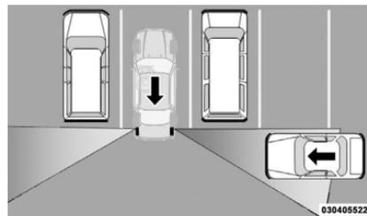
El sistema vigila las zonas de detección traseras de ambos lados del vehículo para detectar los objetos que se mueven hacia los laterales del vehículo a una velocidad mínima comprendida entre 1 km/h y 3 km/h aproximadamente y los objetos que se mueven a una velocidad máxima de unos 35 km/h, como suele suceder al estacionar.
