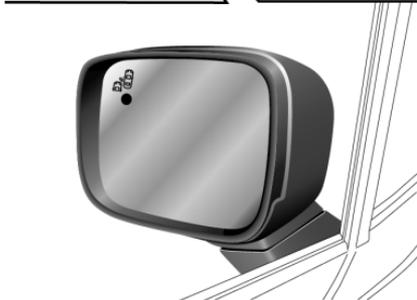
Al arrancar el vehículo, el testigo se enciende para indicar al conductor que el sistema está activo.
