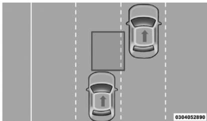
El sistema detecta vehículos que se acercan por la parte trasera del vehículo en ambos lados y entran en la zona de detección trasera con una diferencia de velocidad respecto al propio vehículo inferior a 50 km/h.
