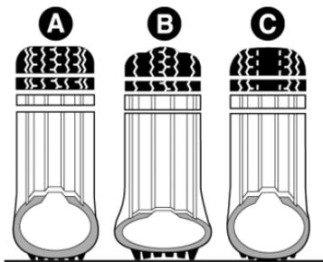
**A** - presión normal: la banda de rodadura se desgasta uniformemente.
