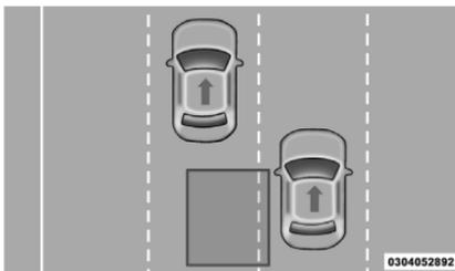
Cuando está adelantando lentamente a otro vehículo con una velocidad relativa inferior a 20 km/h, el testigo en el espejo retrovisor externo del lado correspondiente se enciende.
