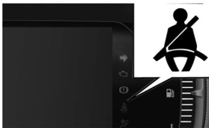
Con el vehículo detenido, si el cinturón de seguridad del lado del conductor está desabrochado o el cinturón de seguridad del lado del pasajero está desabrochado (en este caso, solo si el asiento del lado del pasa-
