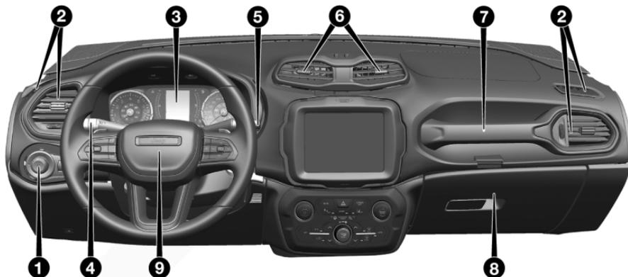
1- Conmutador de las luces externas 2- Difusores de aire laterales 3- Cuadro de instrumentos 4- Palanca izquierda (mando de las luces de carretera y luces de giro) 5- Palanca derecha (mando de limpieza/ lavado del parabrisas y luneta 6- Difusores de aire centrales 7- Asidero 8- Guantero 9- Volante
