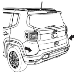
El sistema alerta al conductor de la presencia de vehículos en las zonas de detección mediante el encendido, en el correspondiente lado, del testigo situado en el espejo retrovisor exterior.
