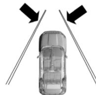
Al detectar una salida o aproximación involuntaria de la línea límite de carril, el sistema puede aplicar una fuerza correctiva en el volante para evitar la salida.
