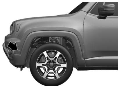
Durante la maniobra y delante de la detección de obstáculos, el conductor también recibe informaciones ofrecidas por los sensores de estacionamiento (4 delanteros y 4 traseros) que suministran informaciones extras sobre la distancia que se debe mantener de los obstáculos existentes delante y detrás del vehículo.
