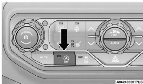
**Interruptor OFF (Apagado) del sistema de Detención/Arranque**
