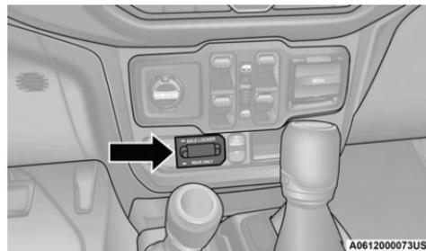
Tablero del interruptor de bloqueo de eje
