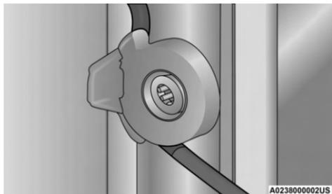
**Correa de la compuerta trasera correctamente asentada**
