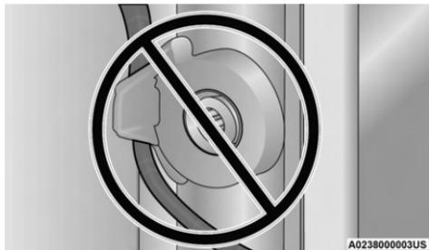
**Correa de la compuerta trasera incorrectamente asentada**
