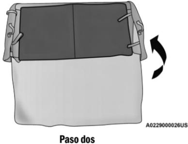
3. Coloque el primer conjunto de la cubierta del panel lateral completamente hacia el lado derecho y el segundo conjunto de la cubierta del panel lateral en el lado izquierdo. Asegure ambos con las dos correas de sujeción de velcro en cada lado.
