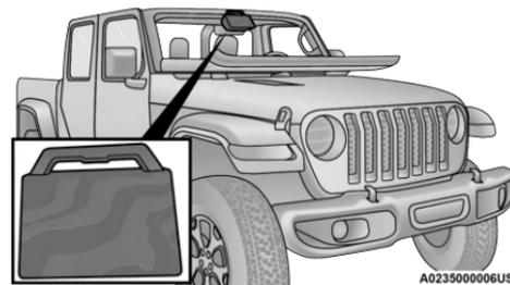
Cubierta protectora instalada
