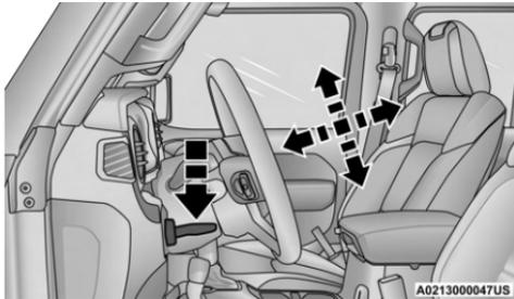
**Control de la dirección inclinable/telescópica de la columna de la dirección**
