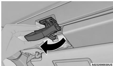
**Acoplar ambos pestillos del cabezal**
