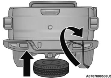
**Reinstalar el neumático desinflado o de repuesto**
