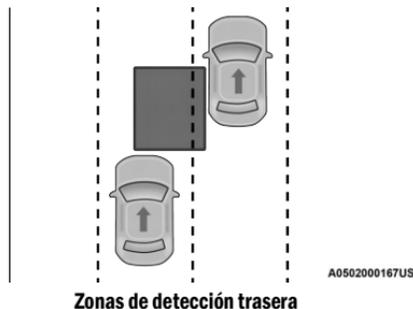
Cuando el vehículo arranca, la luz de advertencia del monitor de puntos ciegos (BSM) se enciende momentáneamente en los dos espejos retrovisores externos para informarle al conductor que el sistema funciona. Los sensores del sistema
