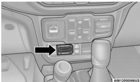
Tablero del interruptor de bloqueo de eje
