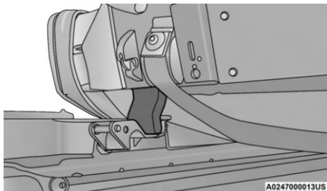
**Retenedor colocado correctamente**
