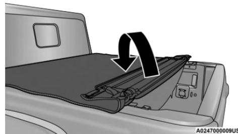
**Enrollar la cubierta Tonneau hacia delante**
