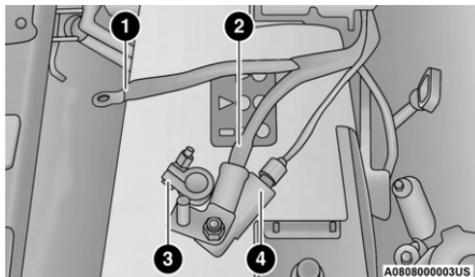
**Desconexión del cable de la batería**
