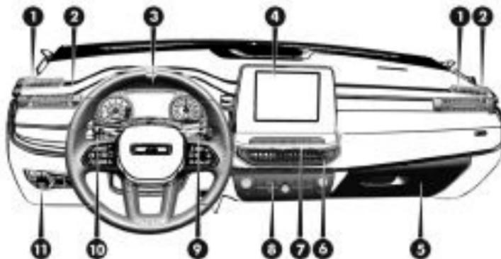
1- Difusores de aire fijos laterales 2- Difusores laterales orientables 3- Volante 4- Central Uconnect 5- Guantera 6- Difusores centrales orientables 7- Conjunto de controles del tablero 8- Controles de aire acondicionado 9- Palanca derecha (control de limpieza/lavado de los vidrios) 10- Palanca izquierda de control de luces de cruce/carretera y luces de dirección) 11- Botones de control.
