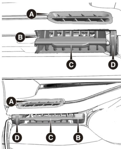
A Difusores de aire laterales fijos (lado del conductor y lado del pasa-
