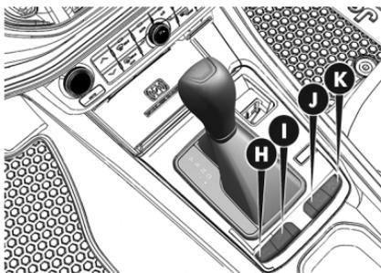
Funcionan solamente con la llave de arranque en la posición **MAR**.
