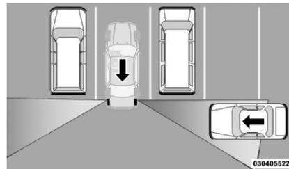
El sistema RCP controla las áreas de detección traseras en ambos lados del vehículo, para detectar los objetos que se mueven hacia los lados del vehículo a una velocidad mínima de aproximadamente 5 km/h y los objetos que se mueven a una velocidad máxima de cerca de 30 km/h, como ocurre generalmente en las plazas de estacionamiento.
