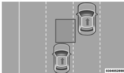
El sistema detecta vehículos que se acercan de la parte trasera del vehículo de ambos lados y entran en el área de detección trasera con una diferencia de velocidad relativa al mismo vehículo inferior a 50 km/h.
