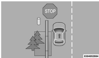
El sistema no señala la presencia de objetos fijos (por ejemplo muros, barrancos en el lado de la carretera, etc.). Sin embargo, en algunas ocasiones, el sistema puede activarse en la presencia de esos objetos. Se trata de un comportamiento normal y no indica una avería en el sistema.
