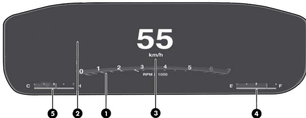
1. Tacómetro; 2. Pantalla multifunción; 3. Velocímetro; 4. Indicador del nivel de combustible; 5. Indicador de la temperatura del líquido de refrigeración del motor.
