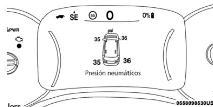
La presión de inflado varía con la temperatura unos 0,07 bar (1 psi) por cada 6,5°C (12°F). Esto significa que una disminución de la temperatura exterior comporta una disminución de la presión de los neumáticos. Ajustar siempre la presión de inflado de los neumáticos en frío. Esta última se define como la presión de los neumáticos después de un periodo de inactividad del vehículo de por lo menos 3 horas o un recorrido inferior a 1,6 km tras un intervalo de 3 horas.
