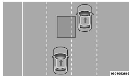
Si la diferencia entre la velocidad de los dos vehículos es superior a cerca de 25 km/h, el testigo no se enciende.
