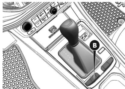
la función 4WD LOCK se puede activar mediante presión en el respectivo botón y el cambio del tipo
