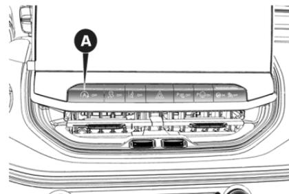
La desactivación del sistema Start&Stop se indica por medio de un mensaje exhibido en la pantalla y/o en el cuadro de instrumentos (dependiendo de la versión). En esas condiciones el LED
