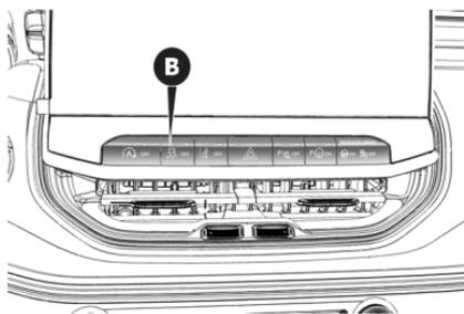
La activación del modo se indica con el encendido del testigo
