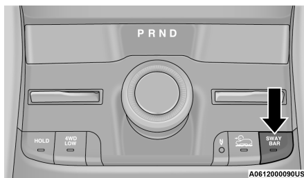
Interruptor de la BARRA ESTABILIZADORA
