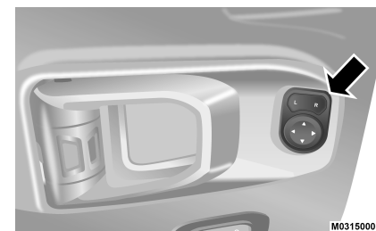
Interruptor de control del espejo eléctrico
