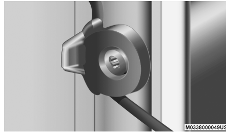
Correa de la compuerta trasera correctamente asentada
