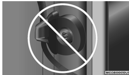
Correa de la compuerta trasera incorrectamente asentada
